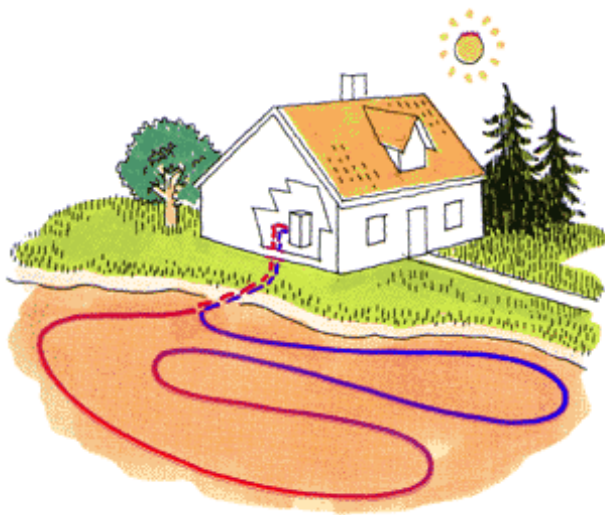
Figur 7: Jordvarmeanlegg. (Kilde: NGU)
