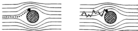
Figur 7.12 Illustration av silning, tröghetsverkan, interception, och diffusion.
