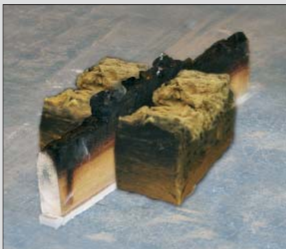
Brannpåvirkning av trekonstruksjon med Rockwool etter 50 minutter.
