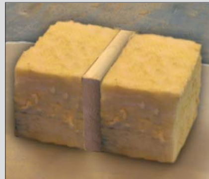
Trekonstruksjon isolert med 150 mm glassull før test.
