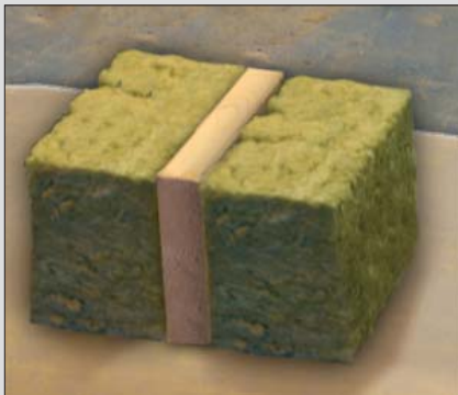
Trekonstruksjon isolert med 150 mm Rockwool før test.
