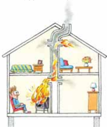
Fig. 11. Brannspredning ved konveksjon
