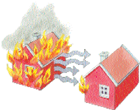
Fig. 10. Brannspredning ved varmestråling
