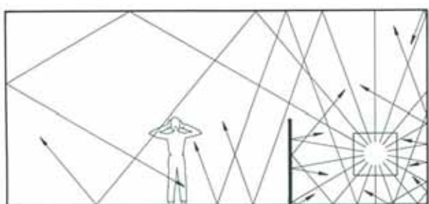
Fig. 5.1 Skjematiske tegninger av lydstrålegang fra en støykilde i et lokale uten og med lydabsorberende Leca flater på tak, vegger og skjermer. Bare de to første refleksjonene er inntegnet. I det første tilfellet treffes mottakeren av et stort antall refleksjoner som gir et økt lydtryknivå.
