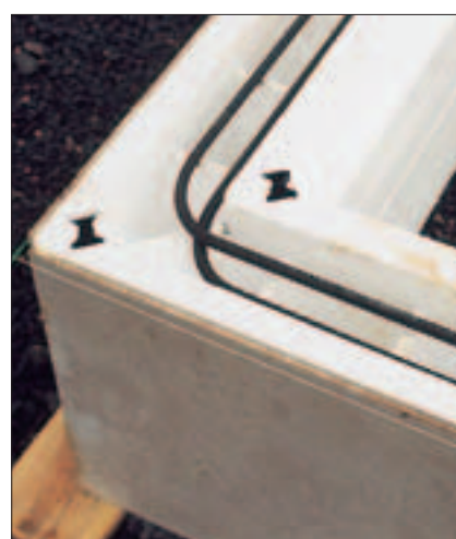
Isotherm Ringmurselement er en kombinert forskaling med ferdigbehandlet overflate av fibersement. Samme element brukes både som rett-element og til innvendige og utvendige hjørner.
