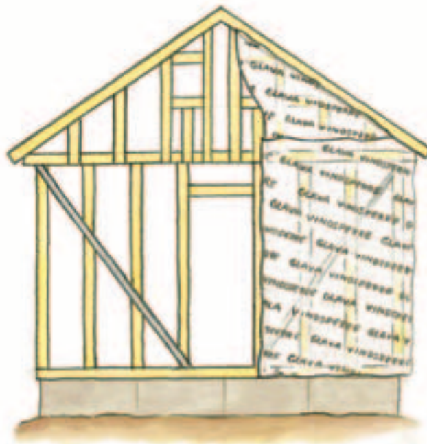
Fig. 93. Viser prinsippet for kryssavstivning av et bygg
