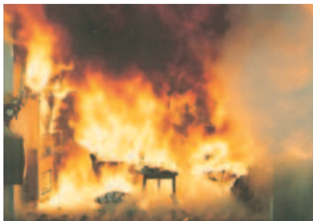
Overtenning. 3 min. 20 sek. etter antennelse
