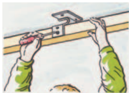
Fig. 70. Feste av lydhimling med lydreduksjonsbøyle
