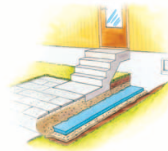
Fig. 86. Telesikring av utvendig trappekonstruksjon.
