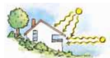
Fig 2.3 Overdekning av bolig i en sørvendt helling hindrer overoppvarming om sommeren samtidig som soloppvarmingen blir utnyttet ved lav vintersol.
