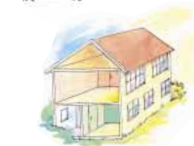
Fig 2.6 Planløsning av boligen bør sørge for at varme rom ligger mot sør og kalde rom mot nord, ev. mot den siden som er mest utsatt for vind. Kalde rom bør også ligge i 1. etasje og varmere rom i 2. etasje.
